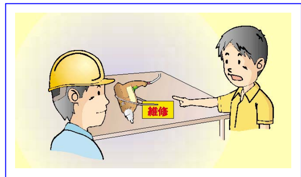
▲ 機具故障時應標示「維修」警告
