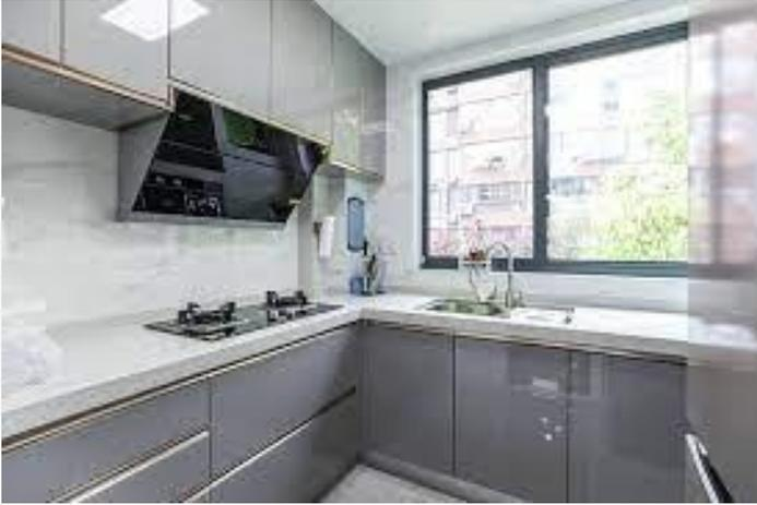
廚房設有**燃燒設備**，裝修材料特別限制應採用**耐燃一級**或**耐燃二級**之防火材料。
